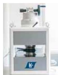
Магнитометры для твердых сплавов
