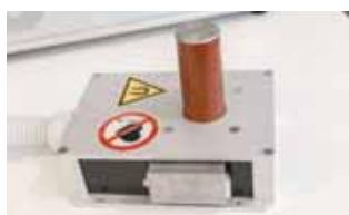
Многополюсные катушки для внутреннего намагничивания, по способу Хальбаха; намагничивание образцов любой формы
